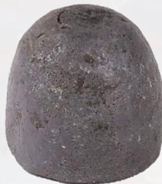
Пуля Нейслера к пехотному ударному гладкоствольному ружью
